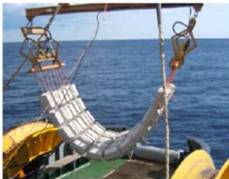
Exemple de protection externe par matelas
